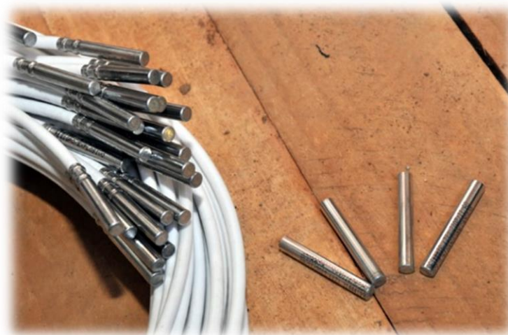
Figura 11 - Espoleta montada a esquerda e espoleta simples a direita
